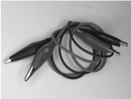
Abb. 3.16: Experimentierstrippen mit Krokoklemmen.
