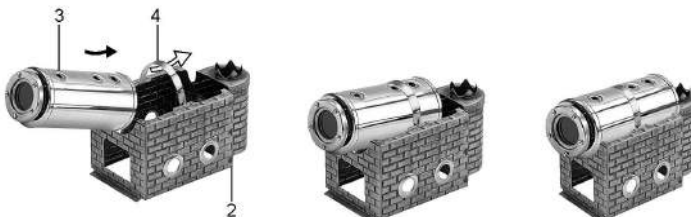
Abb. 2.2.1: Montage des Kessels
