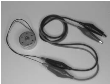
Abb. 3.20: a) Verbindung von Generorkabel und Krokoklemmen b) Detail, wie das Kabel eingeklemmt wird, sodass es einen guten Kontakt hat.
