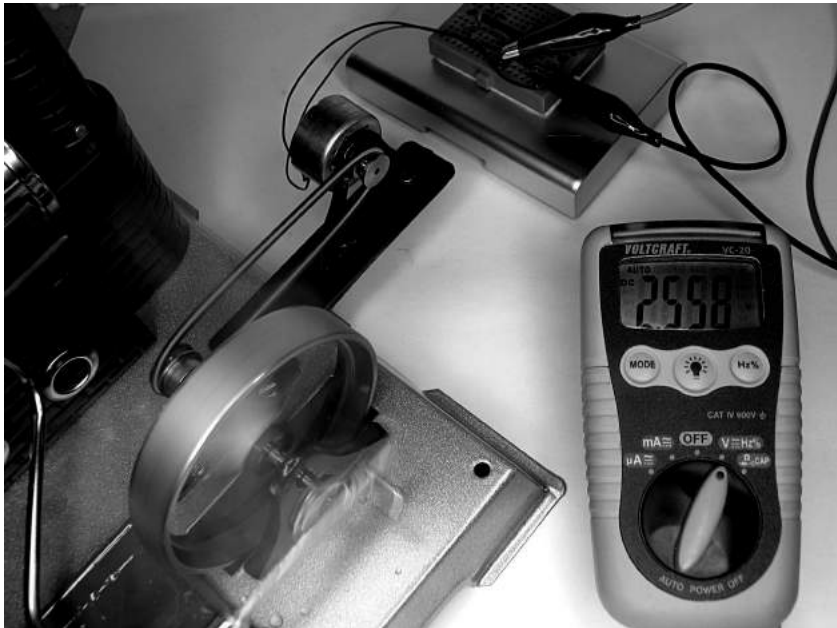
Abb. 3.29: Messen der Generatorspannung mit dem Multimeter, Messaufbau
